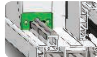
ALT SÜRME KAPAĞI sayesinde sürme kanat kapamanın manuel olarak ray şeklinde kesilmesine gerek kalmadan estetik görünüm sağlanırken kapamanın raya sürme riski ortadan kaldırılmıştır.
